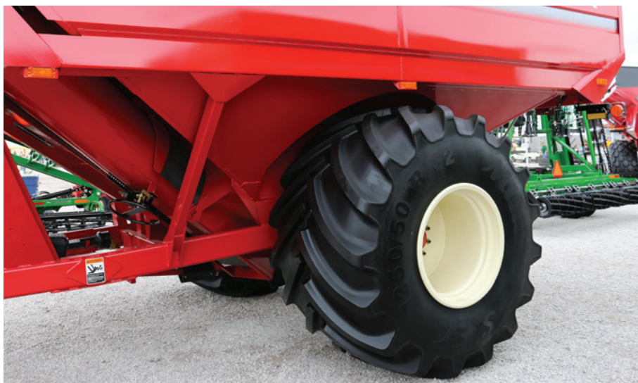
Pneumatika Mitas 1250/50R32 SFT na velkoobjemovém valníku na obilí Unverferth 1015 Xtreme. Se svou šířkou 1220 mm a vnějším průměrem 2020 mm patří tento plášť k největším v portfoliu značky Mitas.
