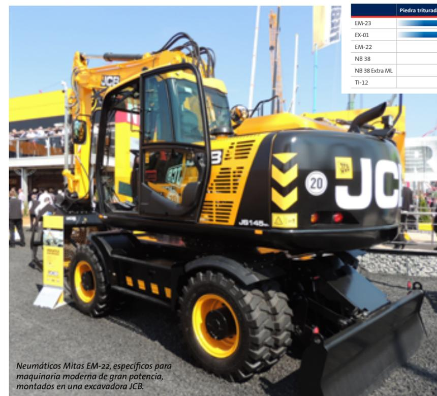
Neumáticos Mitas EM-22, específicos para maquinaria moderna de gran potencia, montados en una excavadora JCB.
