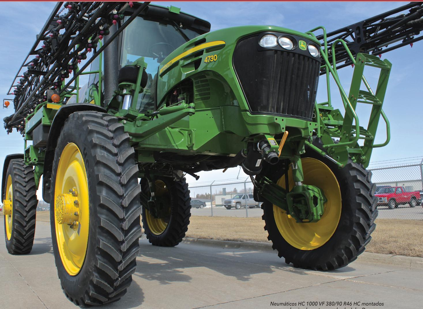
Neumáticos HC 1000 VF 380/90 R46 HC montados en un pulverizador autopropulsado John Deere.
