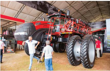
Pulverizador autopropulsado Case equipado con neumáticos HC 1000 VF 380/105 R50.
